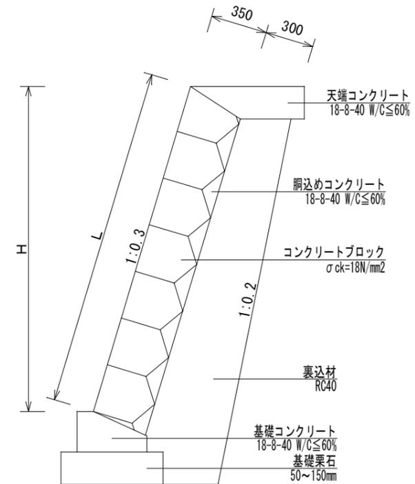
※水抜きパイプは、2.0~3.0m2に1箇所φ50mmをL.W.L以上に設置すること。
