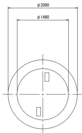
圧入掘削完了断面図
