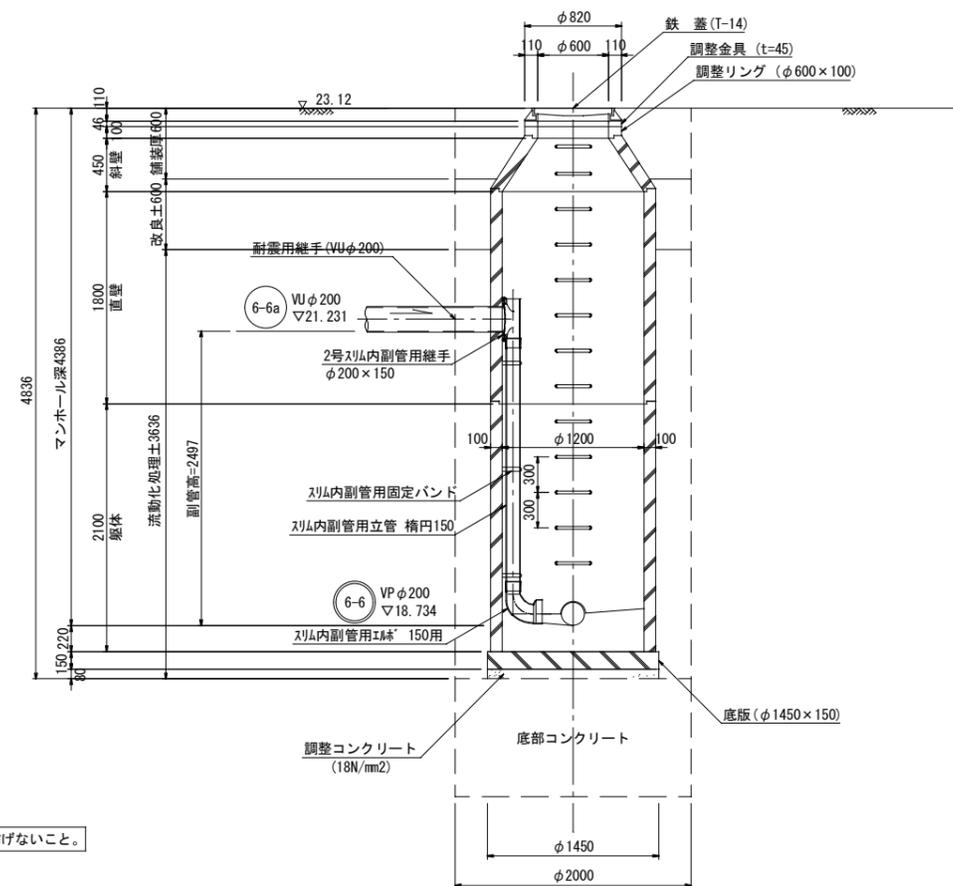
※ 埋戻材により耐震可とう部の機能を妨げないこと。
