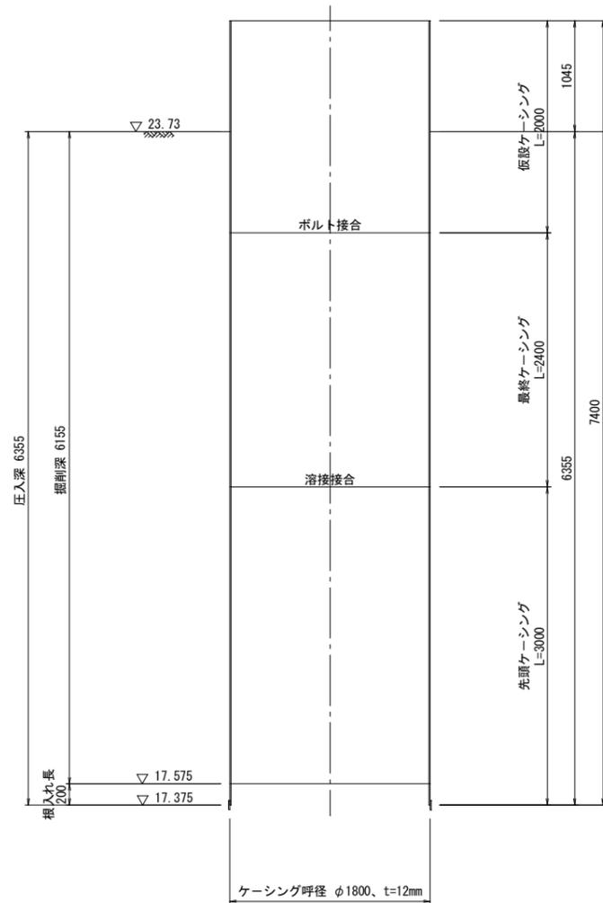
底盤コンクリート打設完了断面図
