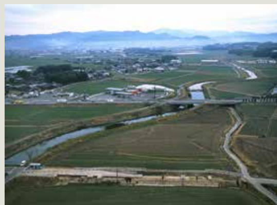
江戸時代、草場川の氾濫に悩んだ久留米藩は、当時の最新治水技術（野越堤・霞堤・横堤）を用いて薩摩街道を洪水から守りました。
