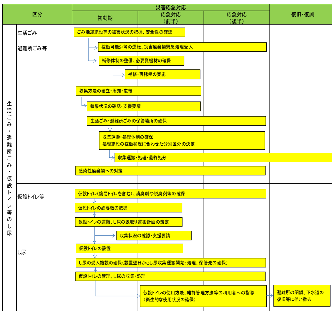
図表 7 被災者（避難者）の生活に伴い発生した廃棄物処理フロー図
